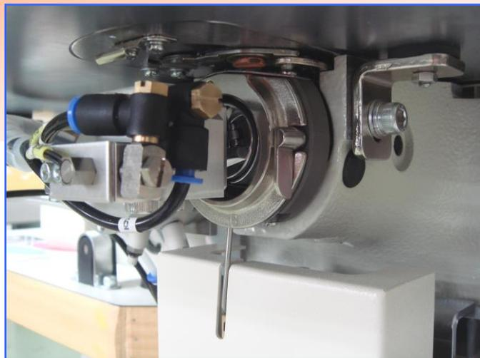
**上糸の通過を検知して目飛びを防止します！**
